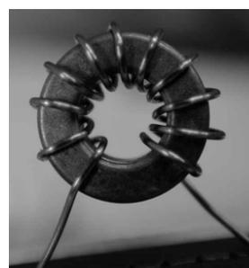
Obr. 43. Praktické provedení cívky na toroidním jádru
