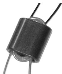
Obr. 20. Praktické provedení balunu na dvouotvorovém jádru
