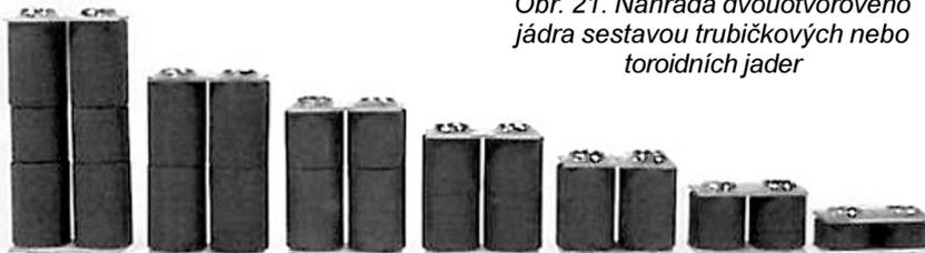
Obr. 21. Náhrada dvouotvorového jádra sestavou trubičkových nebo toroidních jader
