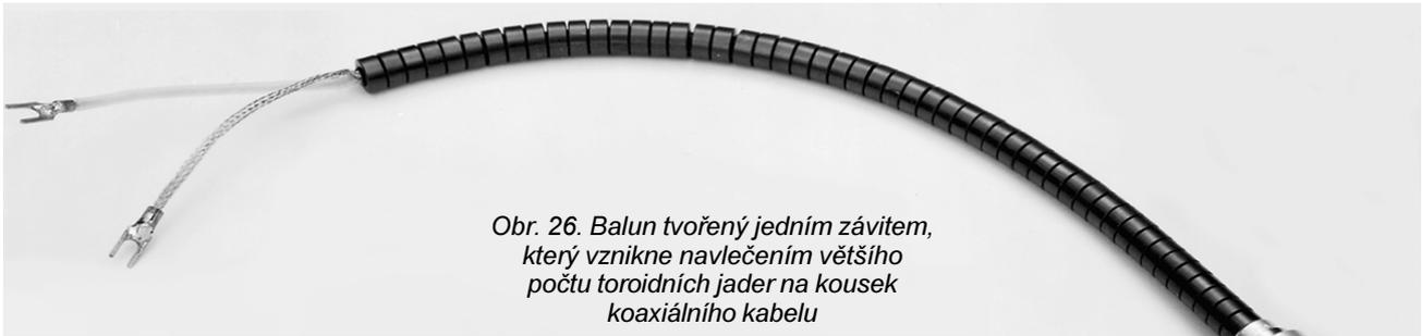
Obr. 26. Balun tvořený jedním závitem, který vznikne navlečením většího počtu toroidních jader na kousek koaxiálního kabelu
